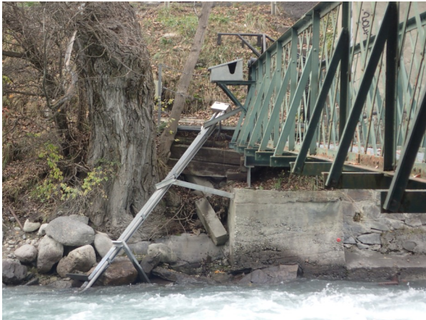
Appareils de mesure de type limnimètre et radar permettant de mesurer la hauteur d'eau
