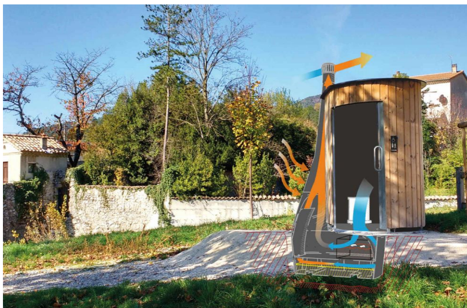
Photo et schéma d'une toilette sèche à déshydratation des fèces et évaporation d'urine.
